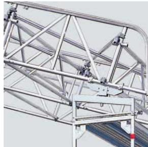
▲ Das Auflager mit 3 Drehachsen und 4 Freiheitsgraden macht den Bau von Sattel- und Pultdächern möglich; Toleranzen im Unterbau werden kompensiert.
